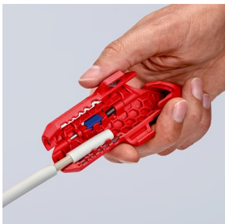
Stripping av en NYM-kabel
